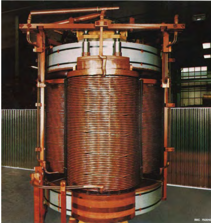
Bild 1: Aktivteil einer Delta-Drossel im Werk Mannheim
