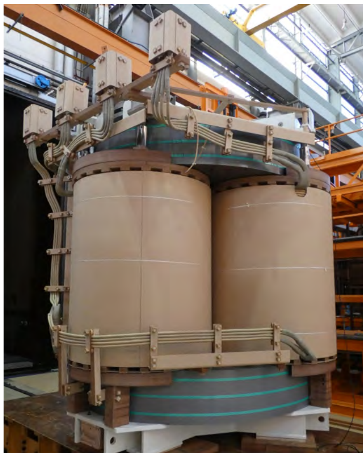
Bild 2: Aktivteil einer Delta-Drossel im Werk Halle
