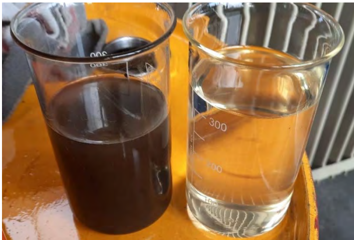
Bild 5: Ölproben vor (links) und nach (rechts) Inbetriebnahme des Filtersystems ES 2000. Das dunkle, schmutzige Öl wies einen hohen Gehalt an Schmutzpartikeln auf (Abrieb von Schleifringen) und führte zu Ablagerungen im Isoliersystem (Kerne etc.).
