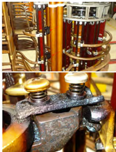
Abb. 5: Beispiel: Heißstelle an Feinwählerkontakt Institut für Elektrische Energietechnik, Fakultät Ingenieurwissenschaften Hochschule für Technik, Wirtschaft und Kultur Leipzig
