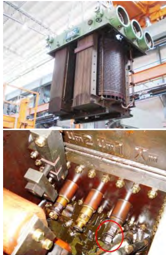
Abb. 8: Beispiel: Kontaktproblem im Kabelanschlusskasten
